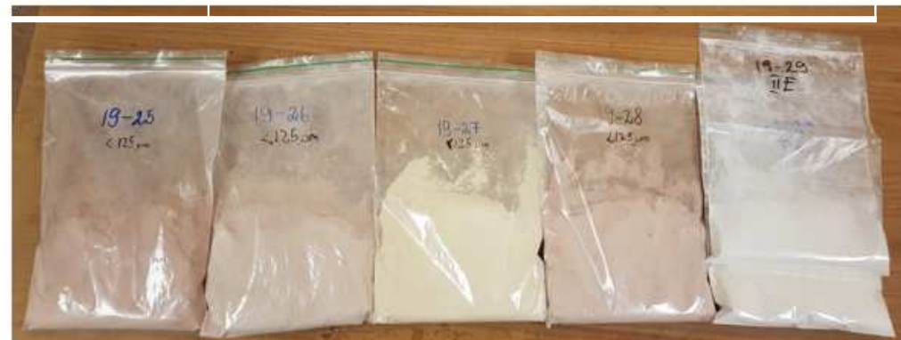
1. attēls. Ar dažādiem šķīdinātājiem (sākot no kreisās puses – Etanols, 2-Propanols, Etilacetāts, 1-Butanols un n-Heptāns) bērza tās ekstrakcijā iegūtie betulīna veidi pētījumam par to izmantošanas iespējām kosmētikas izstrādājumos
